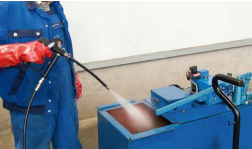
Gründliche Hochdruck-Spül-Reinigung des Hydrauliktanks
