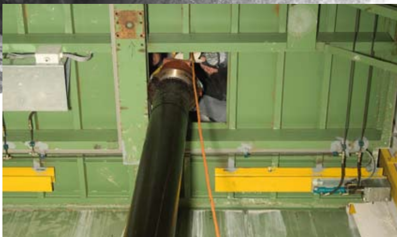
Ziehen des Hydraulikzylinders
